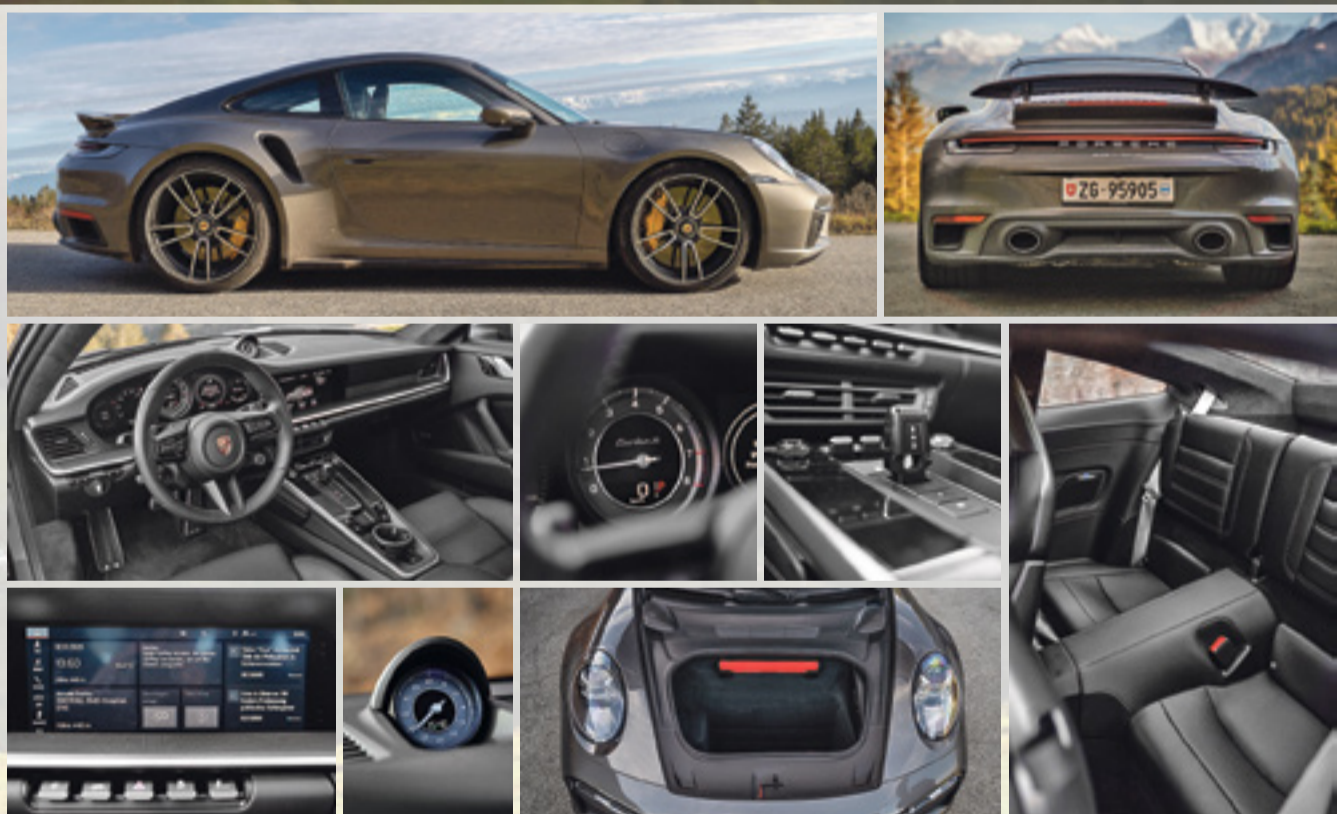
Gegenüber dem Vorgänger ist der Elfer vorne um 45 und hinten um 20 Millimeter breiter geworden. Zwischen den LED-Frontscheinwerfern bleibt Platz für den Kofferraum, der Boxermotor sitzt im Heck hinter den beiden Notsitzen. Die variablen Lufteinlässe verbessern die Aerodynamik. Von hinten erkennt man den 992 am durchgezogenen Leuchtband.
