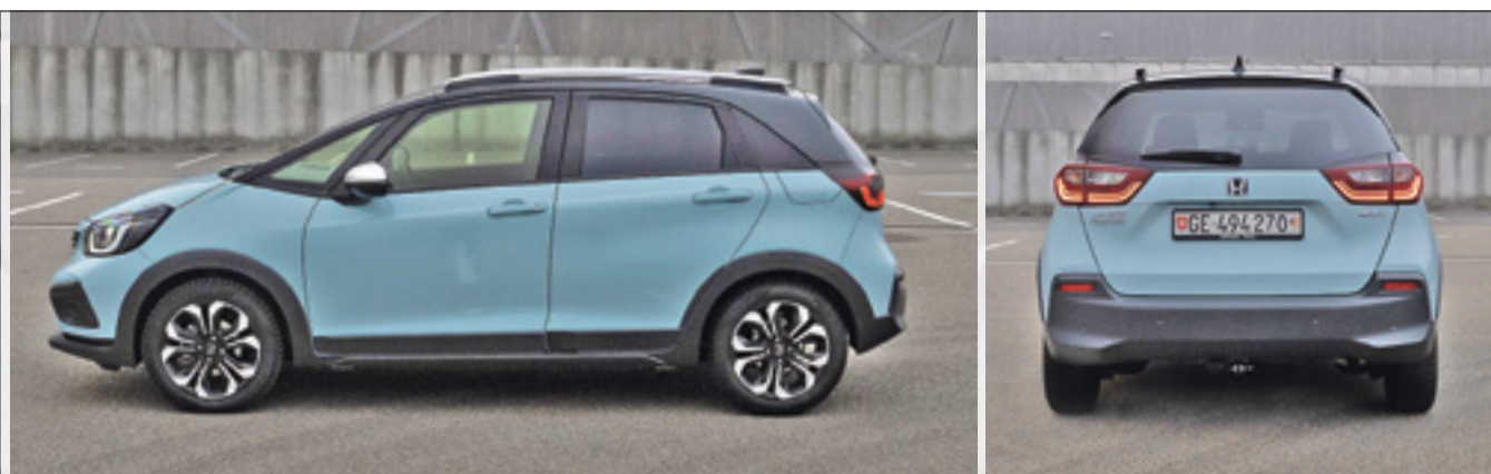
Eine gute Rundumsicht wie im Honda Jazz ist heute nicht mehr selbstverständlich. Dank seiner vanartigen Konstruktion bietet er viel Platz. Speziell für die Crosstar-Version: 30 Millimeter mehr Bodenfreiheit und Radläufe aus Kunststoff.
