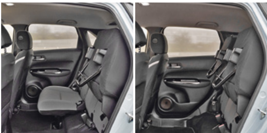
Dank der Magic Seats bietet sich viel Stauraum auch im Fond, ohne dass die Rücksitzlehne heruntergeklappt werden muss.
