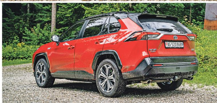
knapp zwei Tonnen schwere SUV flott vorwärtszubewegen. Für den Allradantrieb kommen aber an der Hinterachse noch einmal 40 kW (54 PS) und 121 Nm hinzu. Gesamthaft stehen so 225 kW (306 PS) zu Verfügung. Das reicht aus, um bei einem ungeduligen Drängler einen überraschten Blick zu provozieren, wenn das bodenständige SUV an der Autobahneinfahrt davonzieht.
