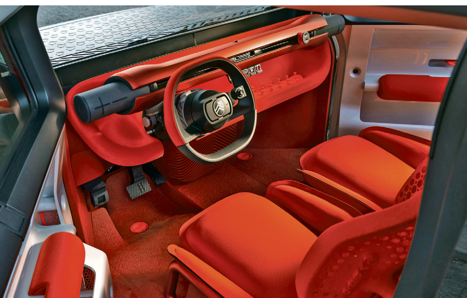
Auch im Interieur ist alles aufs Minimum reduziert. Das betrifft nicht nur die Ausstattung, sondern genauso den Ressourcenverbrauch. Für das Cockpit müssen deshalb ein Lenkrad, eine Smartphone-Halterung, fünf Kippschalter zur Klimasteuerung sowie ein schmaler Displaystreifen genügen. Die Sitze bestehen zu 100 Prozent aus recycelbarem Material.
