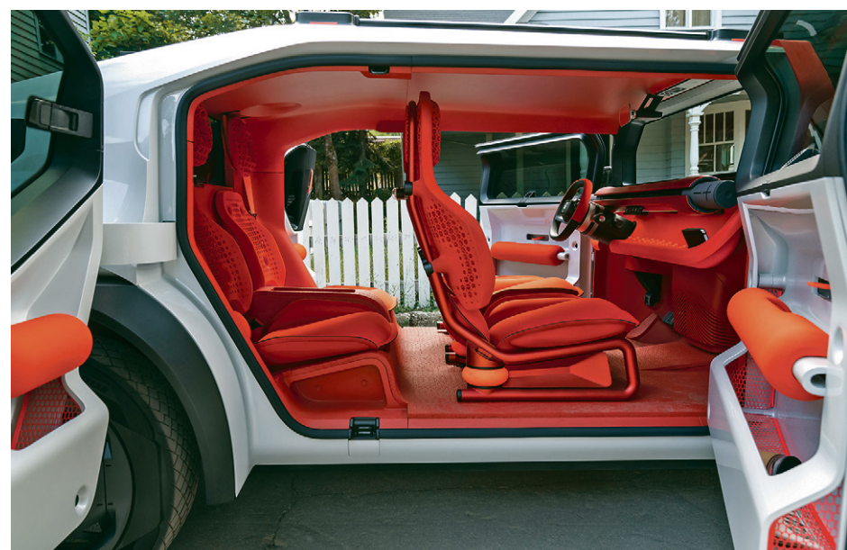
Allein bei den Türen hat Citroën im Vergleich zu einem Familienkombi nur halb so viele Bauteile gebraucht und ihr Gewicht um 20 Prozent reduziert.
