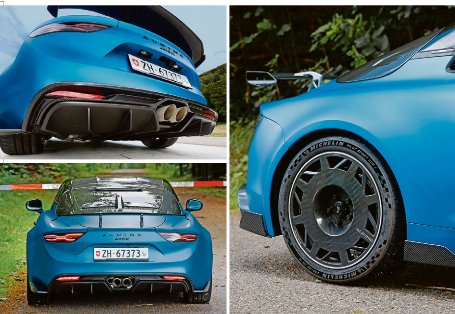
Aerokunst aus Kohlenstoffasern, die Aerofelgen sparen 12.5 Kilogramm an Gewicht ein. Ohne Parksensoren ist genügend Abstand angebracht.
