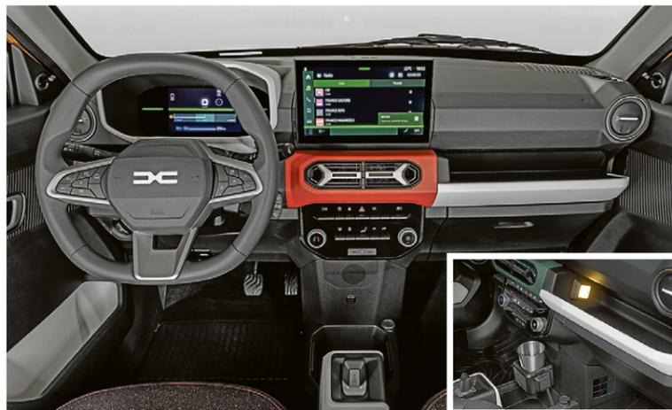
Neuer Look: Armaturenbrett mit zwei Bildschirmen, der Wählschalter ermöglicht es jetzt, das regenerative Bremsen zu verstärken. Das System Youclip bietet eine 3-in-1-Vorrichtung. Unter der Fronthaube, nicht weit von der Ladebuchse entfernt, kann das Ladekabel untergebracht werden.
