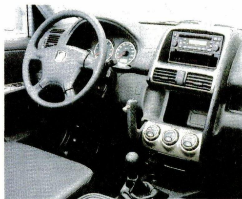
Ungewohntes Bild: Aus dem Armaturenbrett ragt der Handbremshebel heraus.
