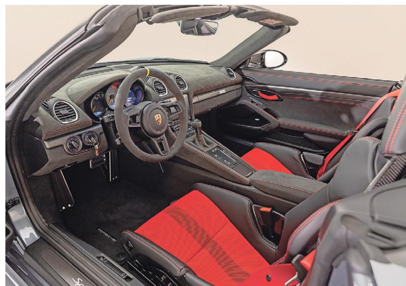
Der Innenraum gleicht dem des GT4 RS – nur das Dach fehlt: RS-Sportlenkrad und Vollschalensitze aus leichtem karbonverstärktem Kunststoff sind Serie.
