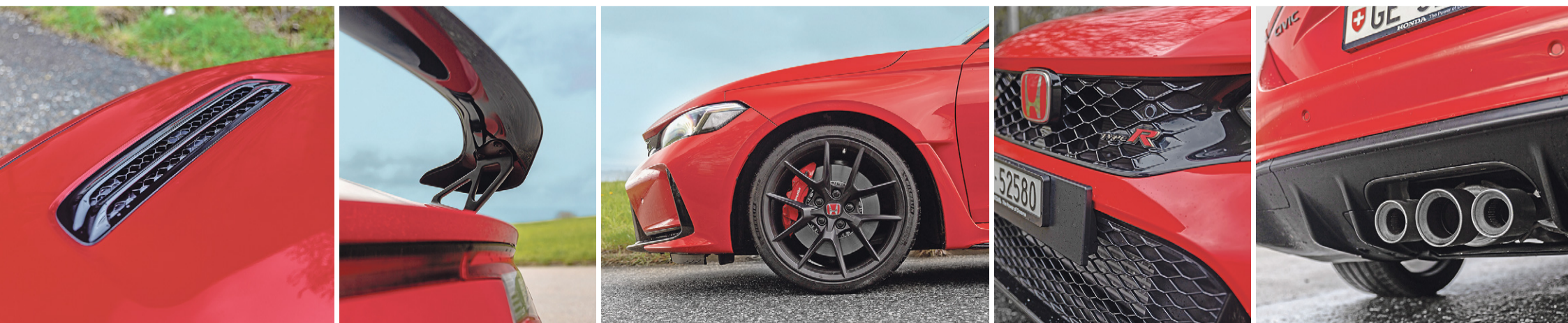
Die Anbauteile des Honda Civic Type R sind nicht mehr ganz so auffällig wie bei früheren Generationen. Die Lüftungsgitter auf der Motorhaube und der Heckflügel sind nicht nur dekorativ. Die Felgen wirken grösser, als sie sind, die Bremsen sind wirklich gross – und kräftig. Die dreiflutige Abgasanlage kennt man vom Vorgänger.
