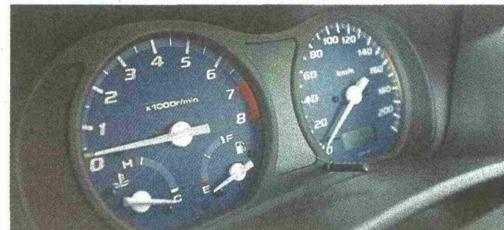
RUNDE SACHE Bei Nacht sind nur die weissen Zahlen und Markierungen der blau hinterlegten und gut ablesbaren Rundinstrumente beleuchtet.
