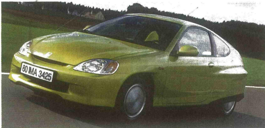
AERODYNAMISCH Die Karosserie des Insight weist einen günstigen Luftwiderstandsbeiwert von 0,25 auf.
