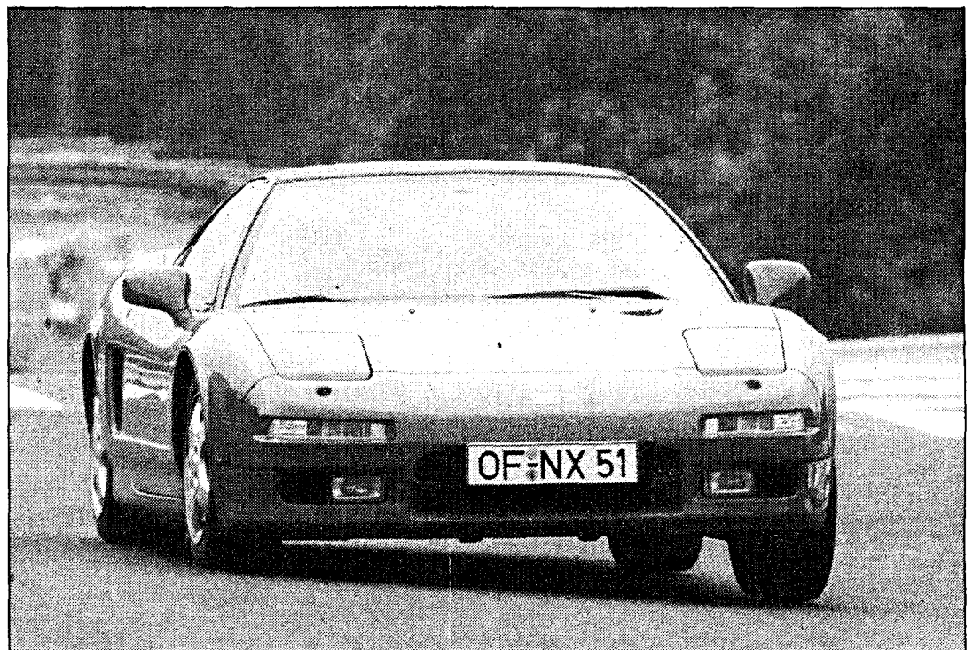
Der Honda NSX besitzt ein effizientes, aber dennoch gutmütiges Fahrverhalten. Gegenüber früheren Prototypen wurde die Aufbauneigung in rasch gefahrenen Kurven deutlich reduziert.
