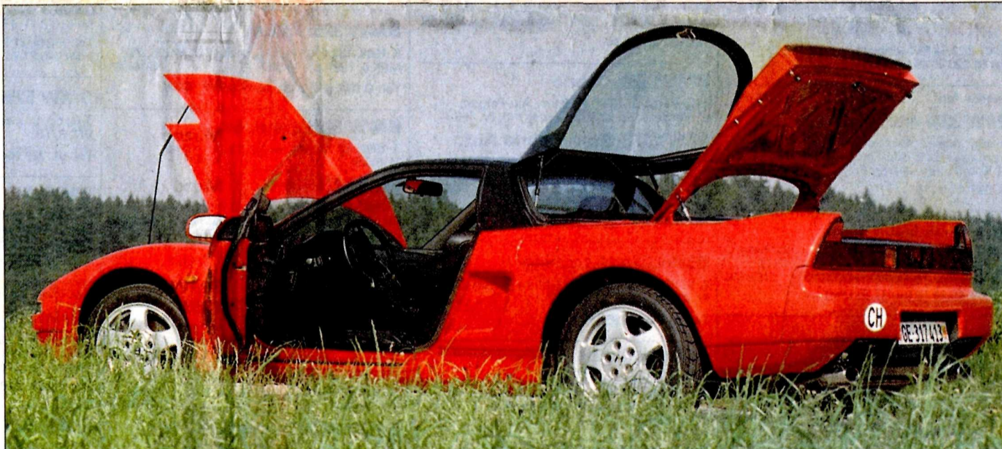
Typisch Mittelmotor – Die Zugänglichkeit gehört nicht zu den Stärken des quer eingebauten V6-Motors. Neben der Glaskuppel muss noch eine weitere Abdeckung angehoben werden. («AR»-Fotos)
