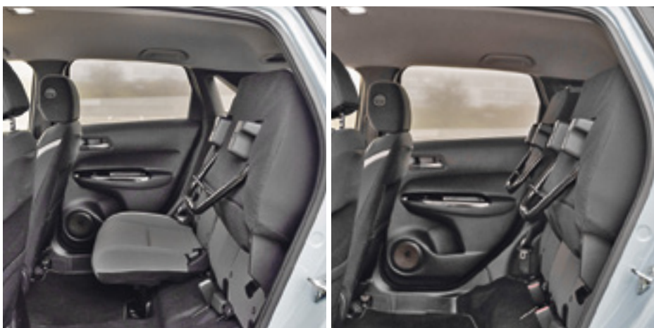
A l'arrière, la banquette arrière profite de la technologie «Magic Seats». Elle permet de stocker des objets encombrants.
